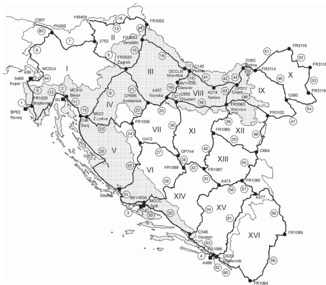
Slika 2. Nivelmanska mreža II. nivelmana visoke točnosti (IINVT)
