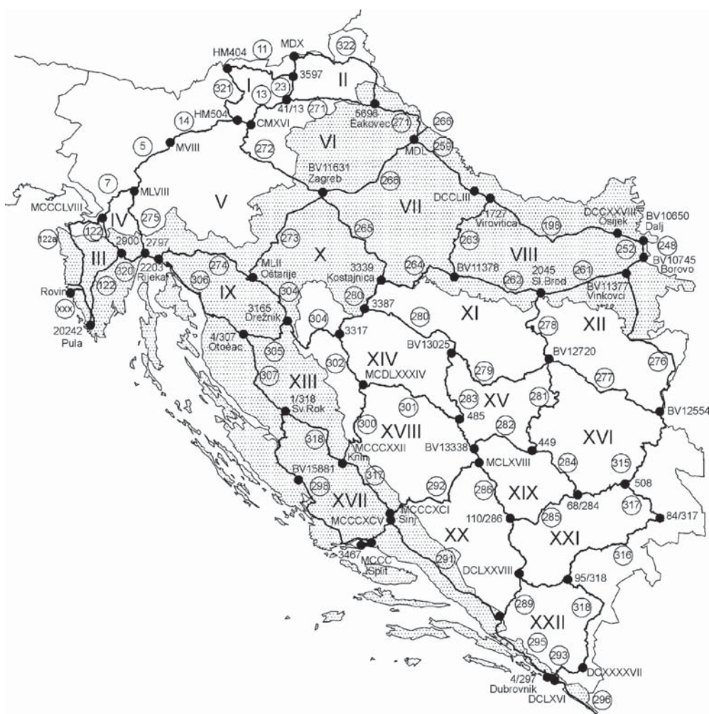
Slika 1. Nivelmanska mreža I. nivelmana visoke točnosti (INVT)
