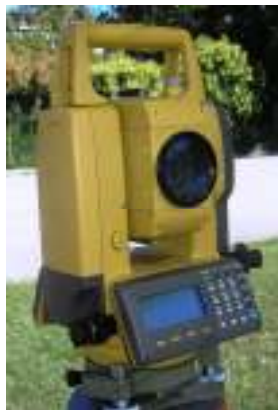
Slika 27. Elektronički tahimetar Topcon GTS105N
