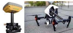
RTK uređaj Topcon Hiper SR Bespilotna letjelica DJI Inspire 1
